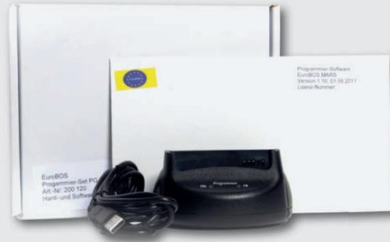
Aufgrund der unterschiedlichen Gehäuse von den beiden digitalen Meldeempfängern wird sowohl für den EuroBOS MARS wie für den EuroBOS ZEUS ein eigenes Programmier-Set benötigt.
