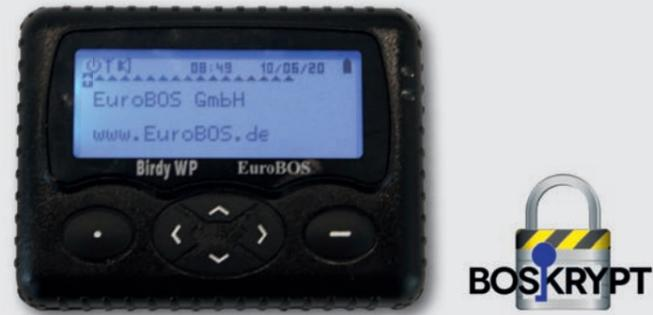
128 RICs | wasserdicht – IP67 | 100-Zeichen-Multi-Color-Display | integrierte BOSkrypt / AES-Verschlüsselung | robust | BOS-Zulassung DME II 62/20
