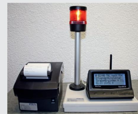
gedrucktes Alarmierungsprotokoll | dokumentenecht und archivierbar | automatischer Zeitstempel | integriertes Tisch-Display
